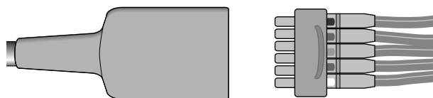
Bild 4-14. Verbinden der Elektrodenleitungen mit der Patientenleitung
